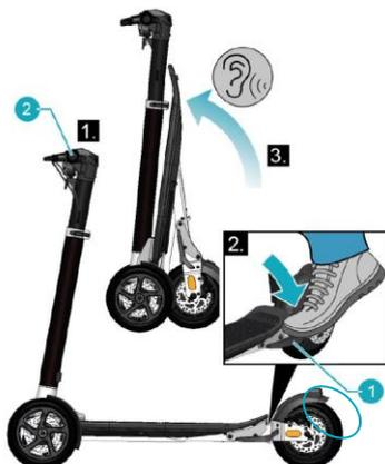
Abbildung 10: Faltmechanismus zuklappen
