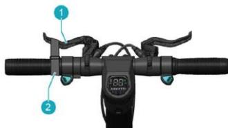
Abbildung 5: Bremse feststellen
