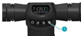
Abbildung 7: Unterstützungsstufen einstellen
